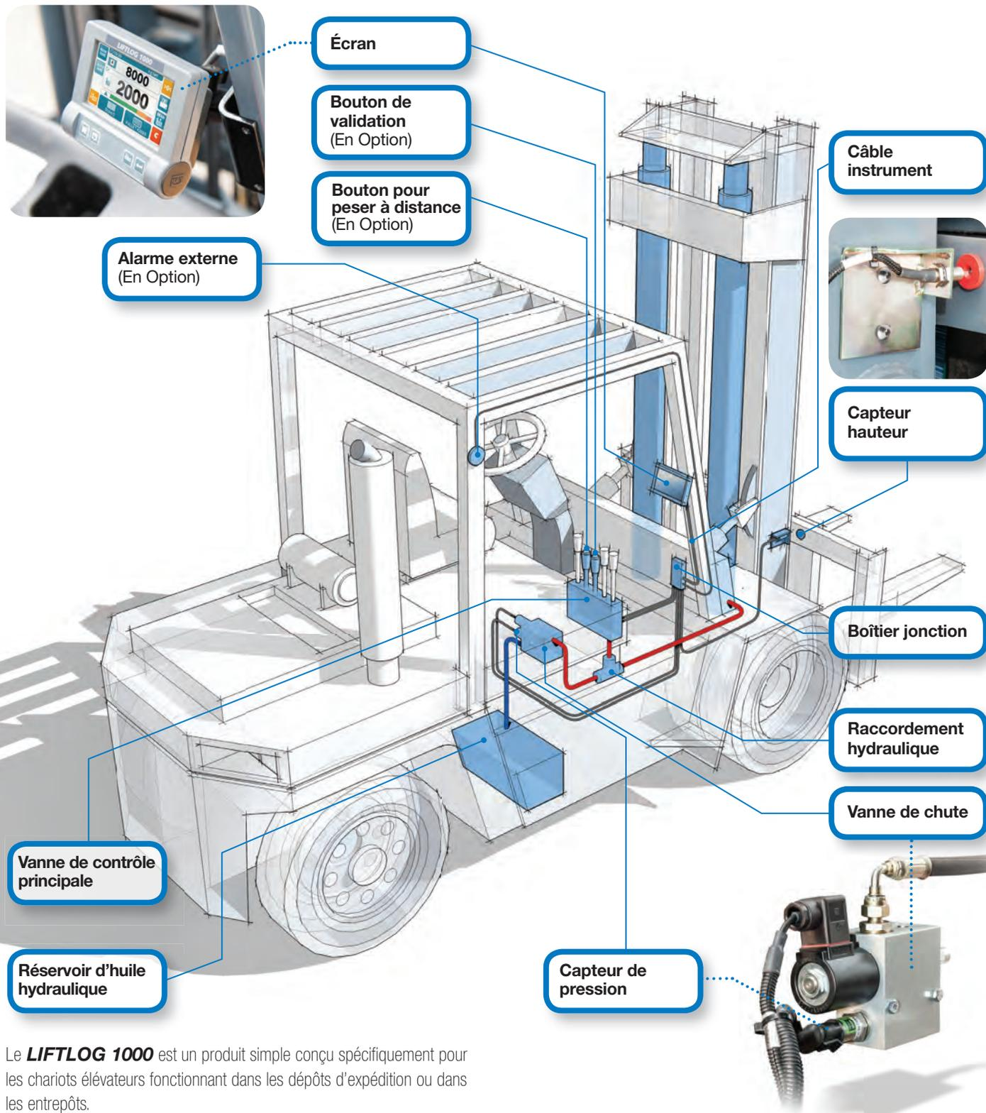
Le **LIFTLOG 1000** est un produit simple conçu spécifiquement pour les chariots élévateurs fonctionnant dans les dépôts d'expédition ou dans les entrepôts.
